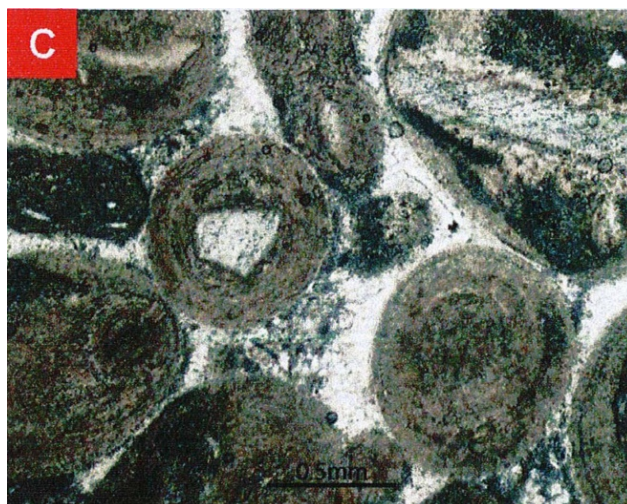
Hình 4. Các hạt pizolit hình bầu dục cấu tạo đồng nhất và trứng cá hình cầu cấu tạo đồng tâm bao quanh nhân mảnh vụn bất kỳ
